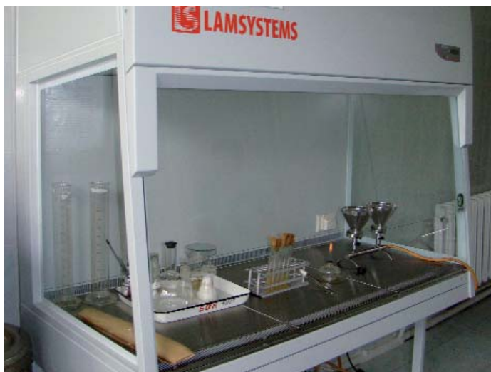
БОКС абактериальной воздушной среды П-01 «Ламинар - С220.150»
