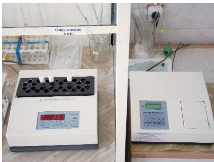
Терморектор «Термион» (слева) и анализатор жидкости «Флюорат 02-3М» (справа).
